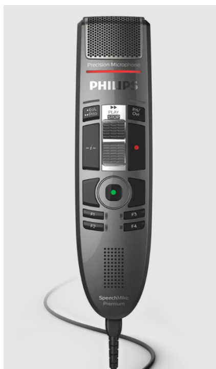
Abbildung 5.1: Darstellung eines Philips SpeechMike mit integrierter Maus (grün markiert), bei dem unbeabsichtigte Berührungen des Feldes zu unerwünschten Cursorbewegungen führen können. [Philips, 2024]
